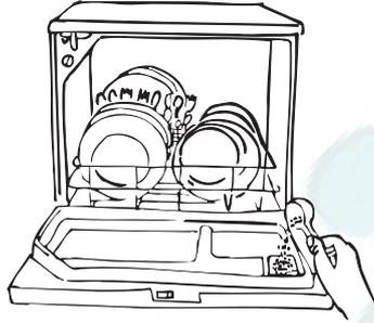
Загрузите посудомоечную машину (см. стр. 8: "Загрузка посуды"). Заполните дозатор ополаскивателя. Поместите в дозатор моющего средства необходимое количество моющего средства и закройте крышку дозатора (модель ESF 245).
