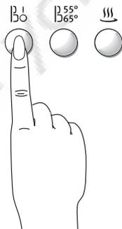
Выберите требуемую температуру и, при необходимости, режим эффективной сушки. Программа начинает выполняться при нажатии кнопки включения/выключения.
